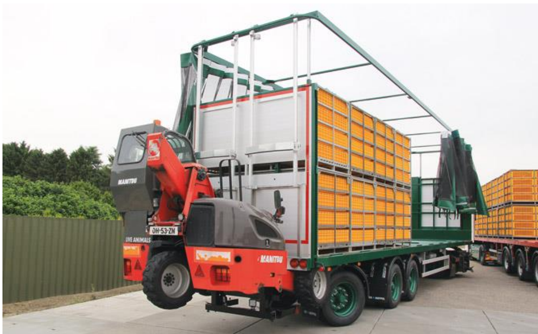
Rysunek 4. Naczepa do przewozu drobiu wyposażona w kontenery i wózek widłowy
